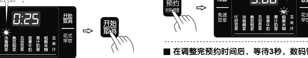
② 再按“开始/取消”键，机器启动，对应功能指示灯常亮，数码管显示“---”。
