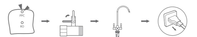
3. 按照下图所示：将滤瓶扳手嵌入到需要更换滤芯的滤瓶盖上，逆时针拧动滤瓶扳手，拧下滤瓶盖，取出寿命到期的滤芯，按滤芯放置指示，将新的滤芯放入滤瓶，并拧紧滤瓶盖（注：反渗透滤芯取下时需要借助老虎钳等工具夹住滤芯中间的塑料中心管，一边转动滤芯，一边向上拔出滤芯）；
